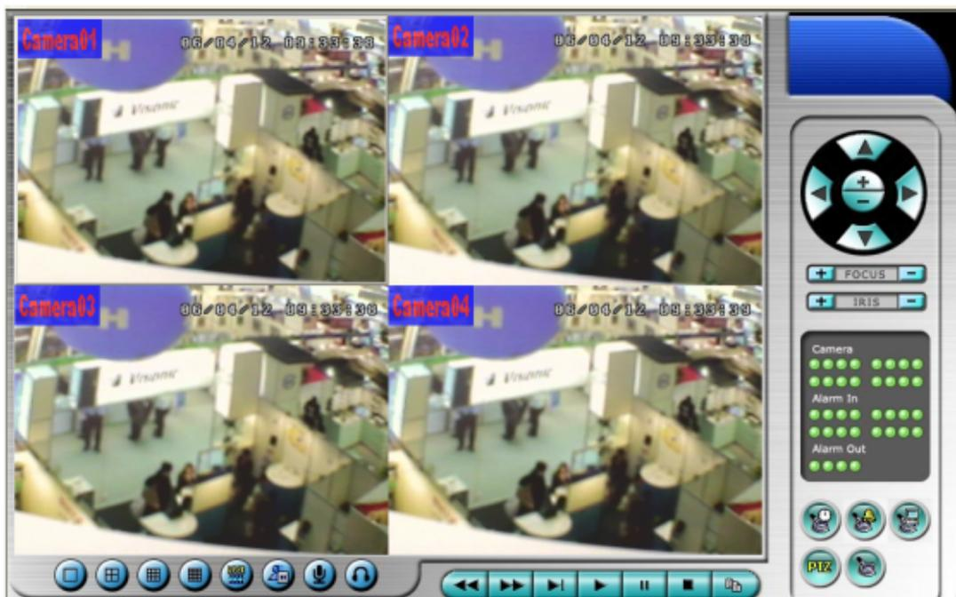
Le immagini video possono essere mostrate secondo un diverso numero di finestre, tra cui 1,4,9 o 16 Finestre. Il nome della finestra selezionata sarà evidenziato in modo luminoso. In aggiunta alle finestre video vi sono diverse icone sia nell'angolo inferiore sia inferiore sinistro, che permettono di effettuare diverse operazioni.
