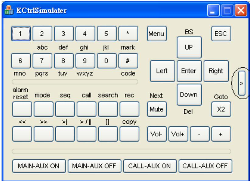
Si noti che molti dei pulsanti corrispondono a quelli sul pannello frontale del DVR. Se si connette il PC attraverso una porta RS-232 e si usa un converter RS-232/RS-485 per connettere più di un DVRs, sarà possibile controllarli tutti tramite il software di simulazione. Fare riferimento alla [Sezione 3.2 Connessioni Opzionali](#) per le connessioni tra DVR e PC.
