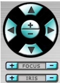
**Pannello di controllo PTZ:** Se la telecamera visualizzata in finestra è una Telecamera PTZ, I pulsanti nel pannello di controllo PTZ permettono di controllarla. Si potrà muovere la Telecamera SU/GIU, a SINISTRA/DESTRA, effettuare lo zoom IN/OUT, il focus VICINO/LONTANO, Iris - + (SCURO/LUMINOSO)
