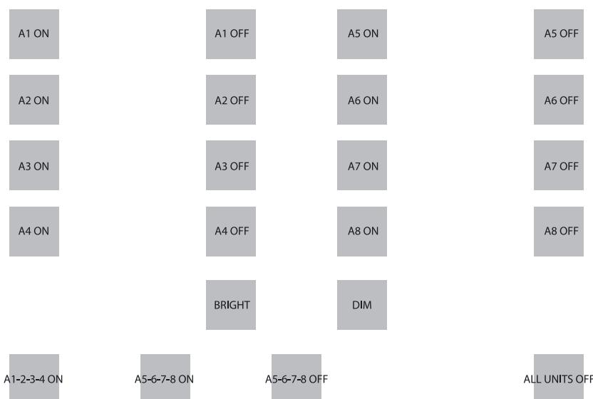
Wenn Sie auf die erste Taste drücken, so wird also die Adresse A1 EIN, versendet werden. Alle bei dieser Adresse (A1) angemeldeten Geräte und Lampen werden also EINgeschaltet werden. Und so weiter.
