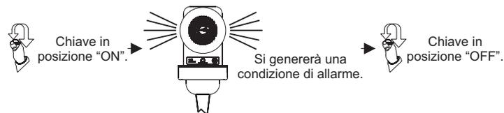
Terminata la segnalazione d'allarme, il LED installato a bordo del veicolo si accenderà con luce fissa per circa 5"; mentre il led è acceso, inserire e disinserire il quadro d'accensione, così che il led si spenga, indicando l'inizio della procedura di sblocco con PIN-CODE.
