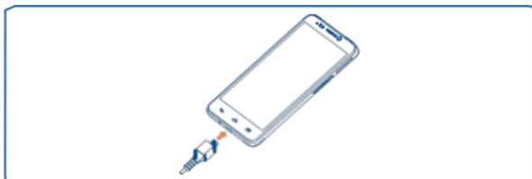
Collegare il caricabatterie al telefono e a una presa di alimentazione. Al primo utilizzo del telefono, caricare completamente la batteria (circa 2,5 ore).
