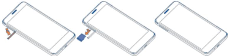
Inserire la scheda SIM nel relativo alloggiamento con il chip rivolto verso il basso, fino a quando non si blocca in posizione.
