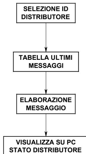
Figura 10.7 Visualizzazione stato del distributore
