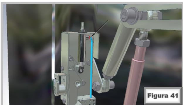
Collegare i cilindretti all'impianto pneumatico con tubi di diametro 4 mm.
