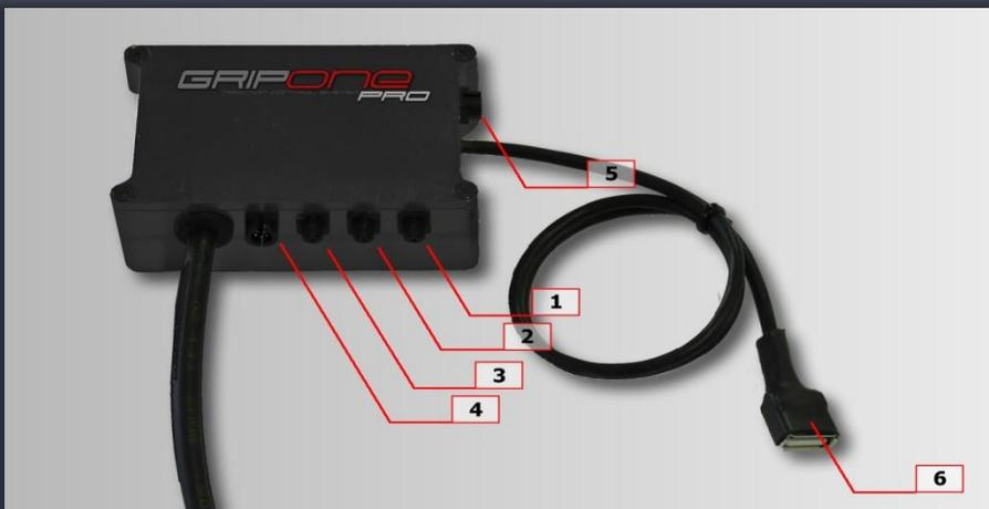
L'altra estremità di tale cavo va collegata al sensore TPS. Il conduttore di colore rosso va collegato al segnale fornito da TPS mentre il conduttore blu va collegato alla massa del TPS. Si consiglia di saldare i terminali del cavo ai pin di connessione presenti sul connettore del cablaggio del veicolo e di ricoprire con guaina termo restringente eventuali parti metalliche rimaste scoperte.
