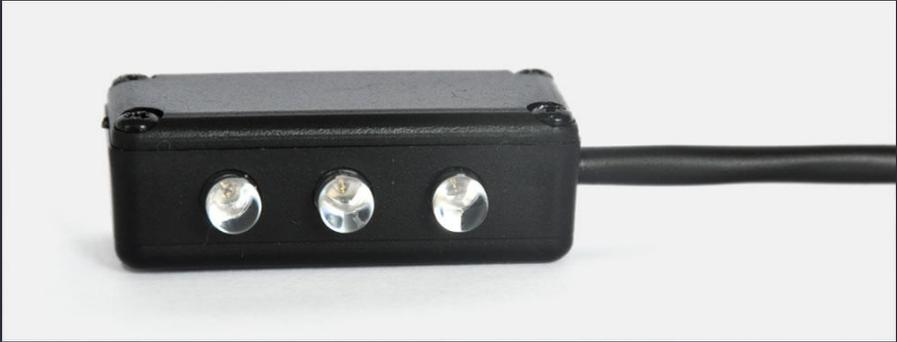
La centralina di controllo GRIPone PRO è predisposta per il collegamento del modulo (accessorio) Remote control, un dispositivo che permette la visualizzazione dell'attività di controllo. Il Remote control, una volta collegato e posizionato in modo da essere visibile durante la guida, informa il pilota quando il sistema di controllo entra in funzione. In ogni istante in cui la centralina effettua un controllo sulla potenza del motore vengono accesi i tre led del Remote control.
