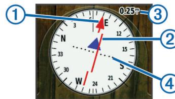
L'indicatore di percorso ① indica la posizione in relazione a una linea di percorso che conduce alla destinazione. L'indicatore di deviazione (CDI) ② fornisce l'indicazione di deviazione (destra o sinistra) dal percorso. La scala ③ si riferisce alla distanza tra i punti ④ sull'indicatore di deviazione, che indica la distanza dal percorso.
