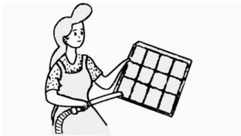
3. Per pulire la polvere che si attacca al filtro si può usare un'aspirapolvere o lavarlo con acqua ed asciugarlo tutto.
