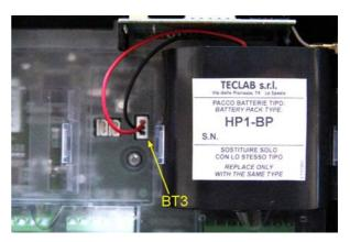
Dopo la sostituzione di una batteria è necessario il riallineamento degli indicatori di autonomia residua.
