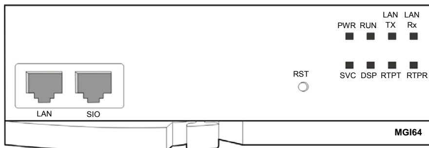
Figura 2.19 Vista frontale della scheda MGI16/MGI64
