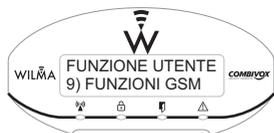
Utilizzando le funzioni GSM è possibile conoscere il livello del campo GSM, il credito residuo e la scadenza della carta prepagata (solo per Centrali versione con modulo GSM).
