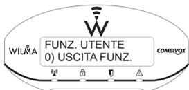
quest'ultima resta attiva finchè non viene espressamente inviato il comando di disattivazione; nel caso di uscita programmata come "Impulsiva", invece resta attivata per un periodo di tempo predefinito, trascorso il quale si disattiva automaticamente. Un'uscita "Impulsiva", comunque, può essere sempre disattivata durante il suo tempo di attivazione premendo il tasto .
