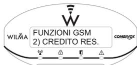
**2) credito res.:** premendo il tasto sul display appare l'ammontare del credito residuo della carta prepagata. Il dispositivo in automatico aggiorna il credito residuo ogni volta che effettua una chiamata o l'invio di un messaggio SMS e periodicamente almeno una volta al giorno.
