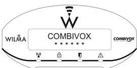
Disinserendo l'impianto si disattivano tutti i sensori collegati. Per disinserire totalmente l'impianto digitare il proprio codice utente.
