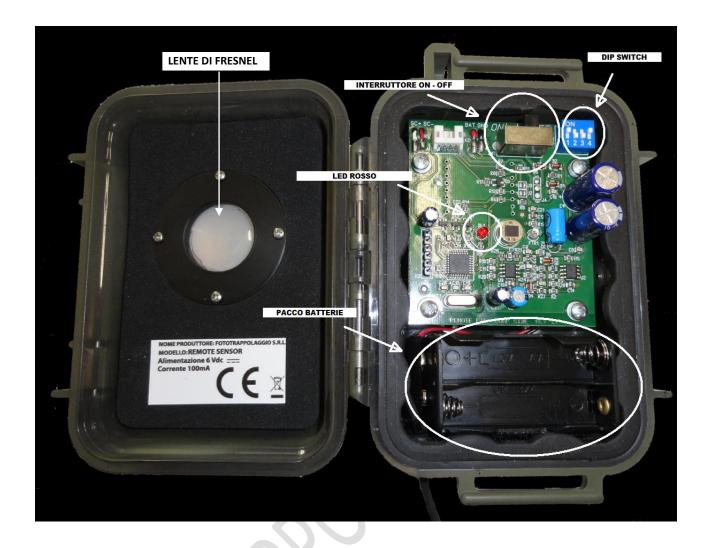
Il circuito elettronico ha nella parte superiore la levetta ON-OFF di accensione e spegnimento, a destra un'unità di regolazione con piccole leve (dip switch) che permettono di impostare i settaggi relativi all'operatività del sensore stesso. Vari sono i settaggi facilmente impostabili e intuitivi (elencati nella tabella sotto).
