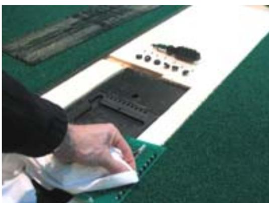
pulire con un panno umido pulito le fotocellule poste sulla scheda elettronica
