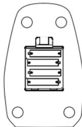
**Il vano batteria si trova sul lato posteriore del dispositivo (vedi figura).**
