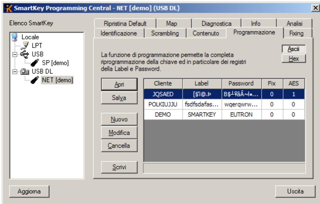
Figura 17 Pannello Programmazione di una SmartKey USB di tipo NET.
