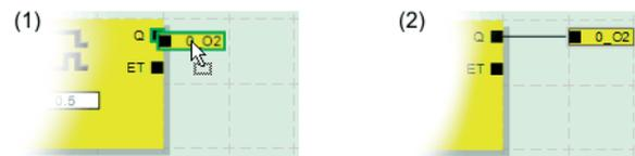
Figura 4-8 Connessione di segnali non collegati a blocchi o funzioni mediante Drag & Drop
