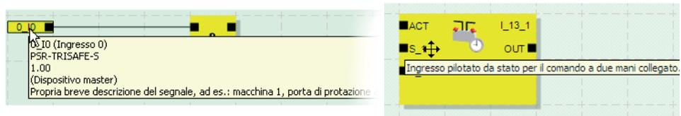
Figura 2-9 Esempi di messaggi descrittivi nell'editor di interconnessione in modalità non in linea (durante l'elaborazione della logica di sicurezza)
