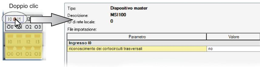
Figura 4-10 Apertura dell'editor di parametrizzazione dispositivi per un determinato ingresso/uscita
