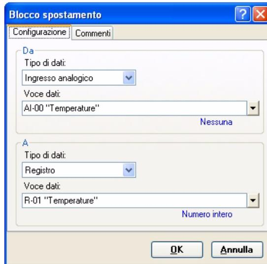
Figura 5-3 Finestra di dialogo "Blocco spostamento" per spostare l'ingresso analogico ad un registro
