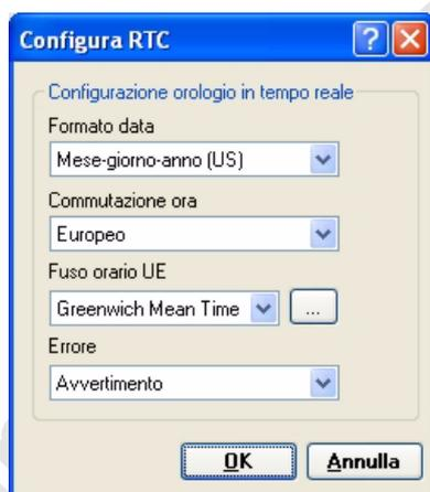
Figura 3-8 Finestra di dialogo "Configura RTC"
