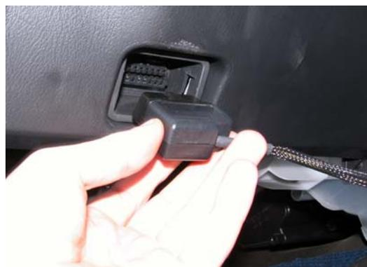
E' possibile che sulla presa OBDII siano inviati direttamente tutti i parametri gestiti dalla centralina dell'auto. Si faccia riferimento al paragrafo 3.1 per maggiori informazioni relative ai canali visualizzabili sui video **SmartyCam**.
