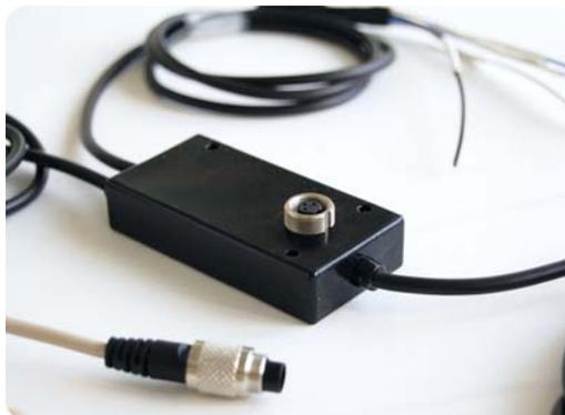
Con **ECU Bridge RS232/CAN** si possono acquisire dati provenienti dalla ECU o dalla presa OBDII del veicolo. Per sapere se la ECU del veicolo sia o meno supportata da **ECU Bridge** e come collegare il veicolo direttamente alla presa OBDII si faccia riferimento alla documentazione scaricabile dal sito AIM “Area download”, “Conessioni ECU”.
