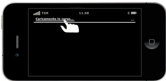
Il collegamento tra il sistema AMICAWEB e il PC o dispositivo mobile avviene tramite LAN o WLAN su rete locale o Internet. Se questa connessione è molto lenta a causa di problemi che in quel momento si possono verificare sulla rete, è possibile che la pagina rimanga in "Caricamento in corso...".
