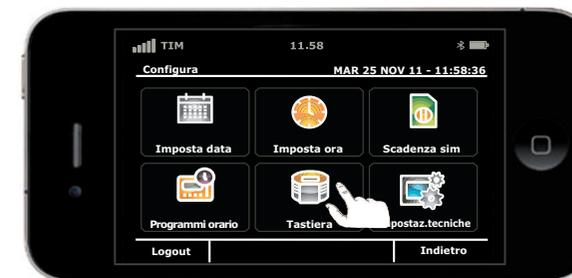
E' possibile attivare la schermata "Emulazione tastiera" che emula la tastiera LCD della centrale Amica 2012. Per impostare l'emulatore della tastiera premere sul tasto "Tastiera" (fig. 25a).
