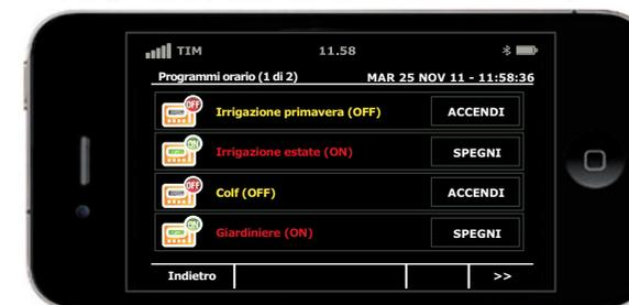
Si accede ad una maschera (fig. 24b), da cui è possibile attivare/ disattivare ogni singolo programma. Qualsiasi programma **deve essere stato preventivamente programmato dal tecnico installatore**.
