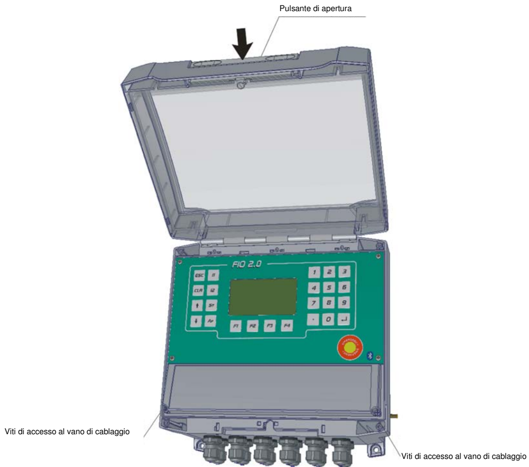
Figura 22 Accesso al vano di cablaggio
