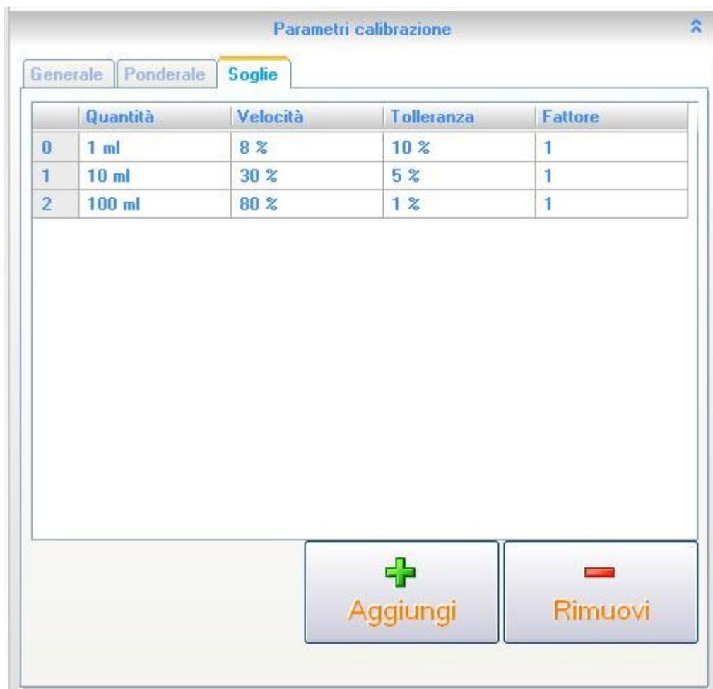
Figura 123: Parametri calibrazione soglie
