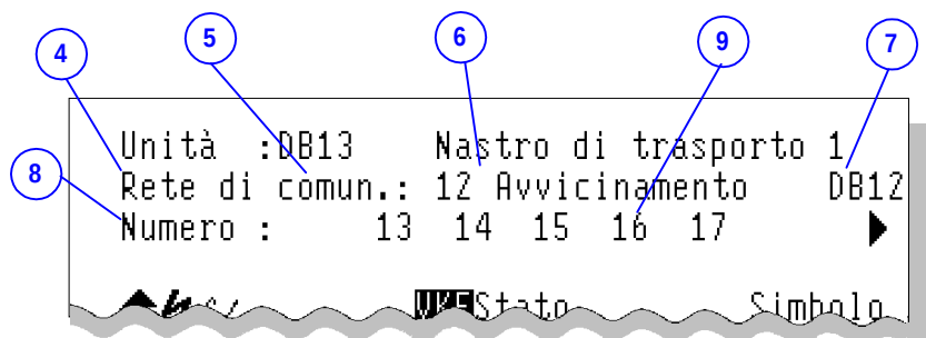
Pagina dettagliata (esempio di variante AWL dell'OP27 programmato con S7-PDIAG)
