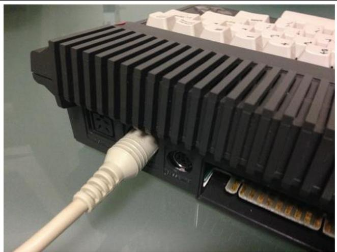
Collegate l'altra estremità del cavo IEC a 6 poli alla presa IEC femmina sul lato posteriore della C64SD
