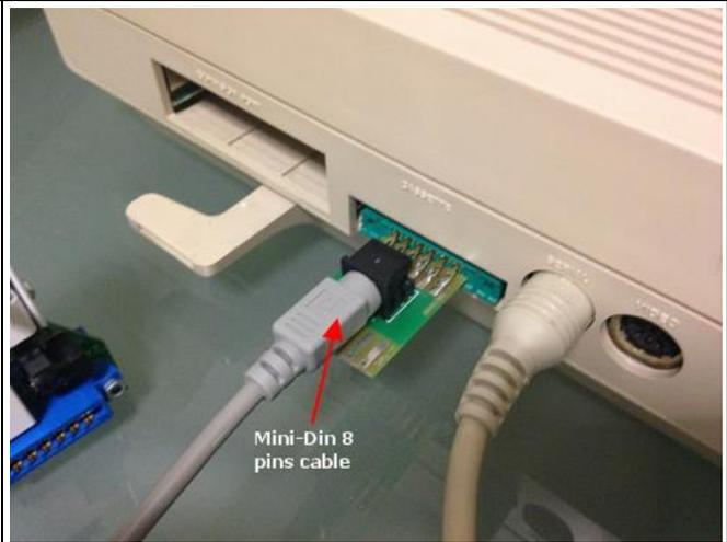
Collegate l'altra estremità del cavo mini-din a 8 poli alla presa mini-din laterale della C64SD
