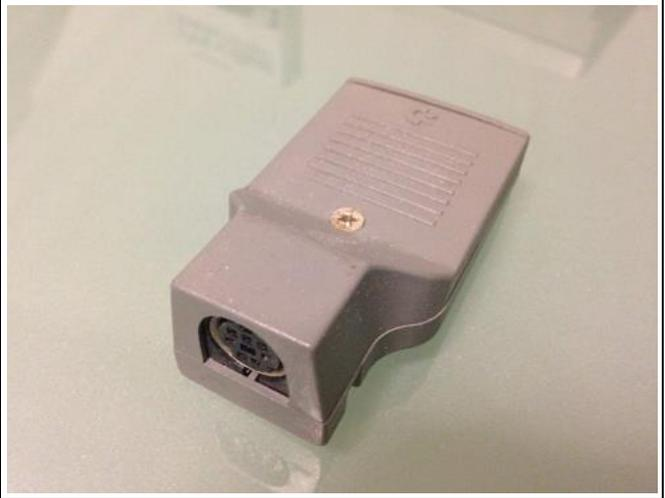
Inserite a fondo l'adattatore nastro nel connettore edge-card posteriore della scheda C64SD. Assicuratevi che la fessura che impedisce di collegare la spina del registratore a rovescio (Mating Key) sia nella posizione indicata in figura
