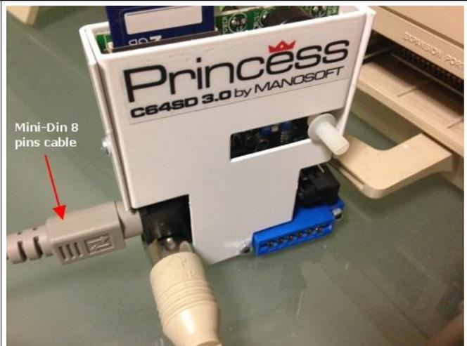
Se non disponete del cavo mini-din ma avete a portata di mano un adattatore da edge-card a mini-din come l'Accessorio 3 potete collegarlo come visibile nella foto. **Fate molta attenzione che la fessura nella spina piatta (indicata come Mating-Key a lato) sia dal lato della C64SD dove è installata la spina IEC maschio.**
