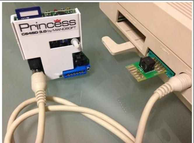
Collegate una estremità del cavo mini-din a 8 poli alla presa femmina dell'adattatore da mini-din a edge-card maschio
