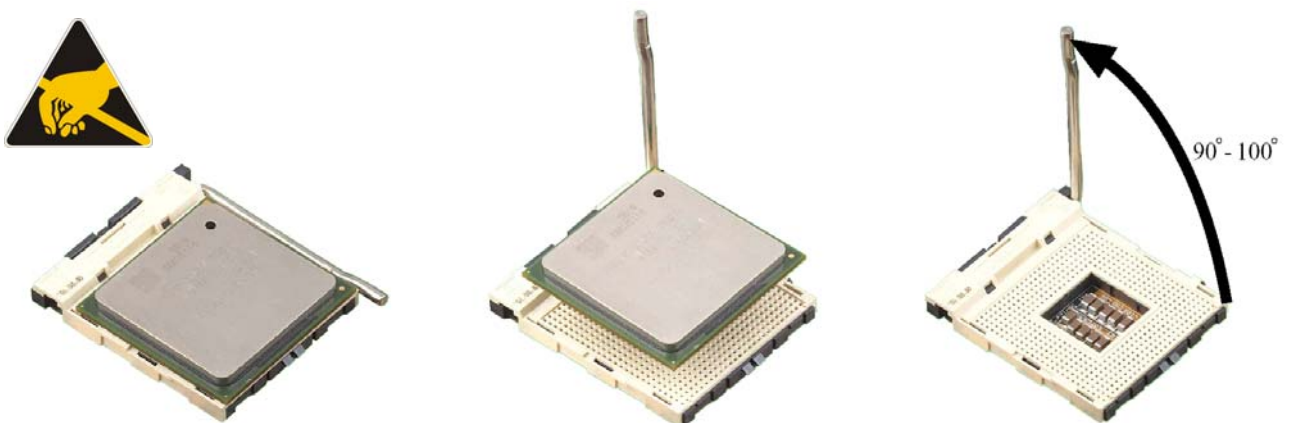
Figura 5. Inserimento/disinserimento della CPU
