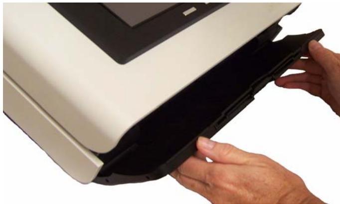
4. Regolare il vassoio di uscita estraendo l'estensione se necessario.
