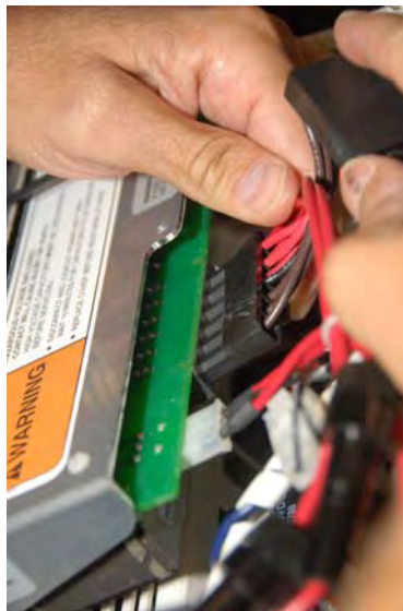
Figura 4 Collegare il cablaggio per prova alla scheda di avvio graduale (dal lato superiore della scheda)
