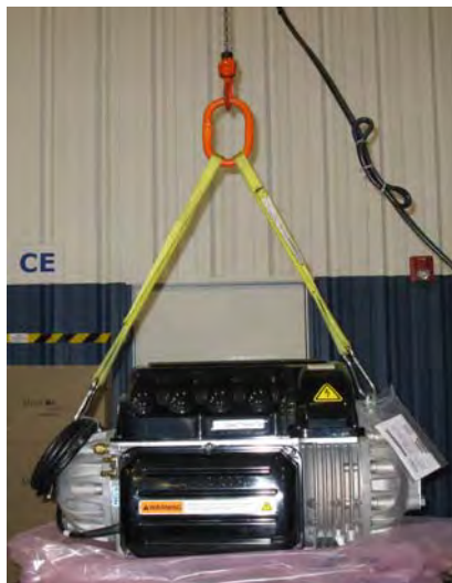
Figura 8 Preparazione per l'ancoraggio
