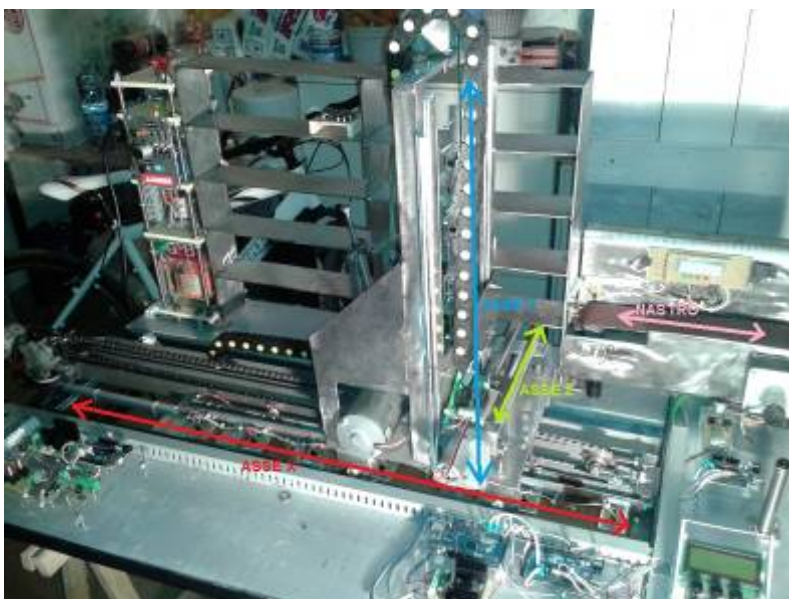
Fotografia del magazzino automatico con schemi degli assi:
