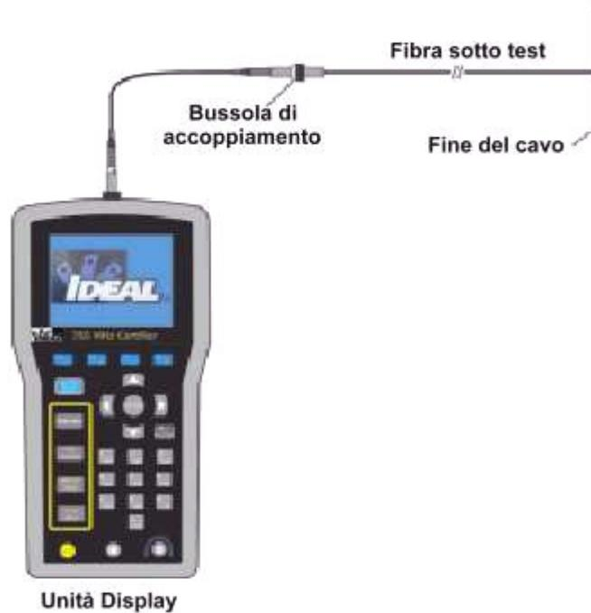
Figura 15: Configurazione LANTEK /TRACETEK
