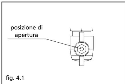
Accedere al rubinetto del gas attraverso le feritoie della copertura raccordi posta nella parte inferiore della caldaia.
