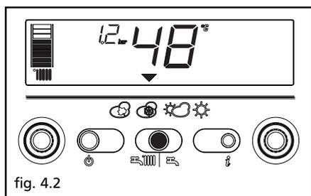
All'alimentazione la caldaia provvede ad eseguire una sequenza di verifica, sul display si visualizzano una serie di cifre e lettere.
