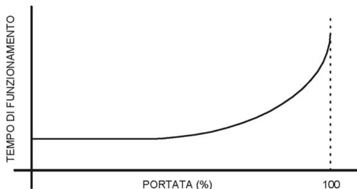
Figura 2-3: CARATTERISTICA TEMPO DI FUNZIONAMENTO
