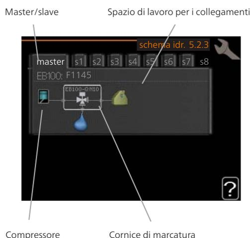
**Master/slave:** selezionare la pompa di calore per la quale occorre effettuare l'impostazione del collegamento (se nel sistema è presente una sola pompa di calore, viene visualizzata soltanto l'unità master).
