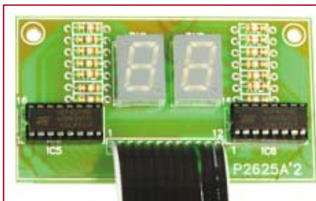
La scheda con i due display a sette segmenti e i relativi driver.
