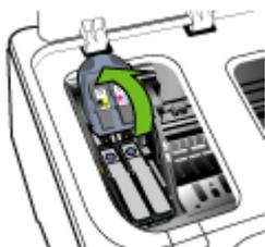
4. Sollevare la leva della testina da sostituire ed estrarre la testina di stampa dal relativo alloggiamento.
