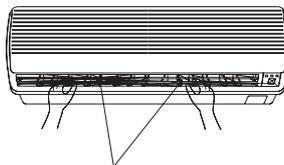
Barre di regolazione orizzontale delle alette / Control rods of horizontal adjustment louvers
