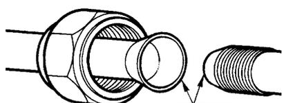
**ATTENZIONE** - È importante che non cadano all'interno dei tubi trucioli, polvere o altro perché intaserebbero il circuito frigorifero all'altezza del capillare causando il blocco dell'impianto o il grippaggio del compressore.
