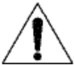
Il simbolo del triangolo con il punto esclamativo serve ad avvisare l'utente della presenza di importanti istruzioni di funzionamento e manutenzione (assistenza) nella documentazione che accompagna il dispositivo.
