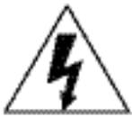
Il simbolo della freccia a forma di fulmine inserito in un triangolo equilatero serve ad avvertire l'utente della presenza di tensione elettrica pericolosa non isolata, all'interno del contenitore del prodotto, che può essere di intensità tale da costituire pericolo di scossa elettrica per le persone.
