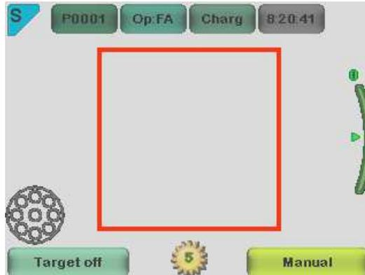
3. Finestra di visualizzazione predefinita quando il modulo ottico FA è collegato utilizzando la modalità AF Assist. La scala delle diottrie è regolata automaticamente, l'immagine può essere catturata quando il pulsante dell'otturatore è premuto a metà.
