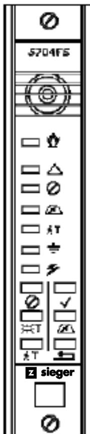
Il pannello è dotato di spie LED per indicare chiaramente lo stato complessivo di tutte le schede di controllo incendi montate sul rack, nonché di un indicatore acustico di allarme e di sei pulsanti di comando. È controllato da un microprocessore posto sulla vicina scheda incendi,
