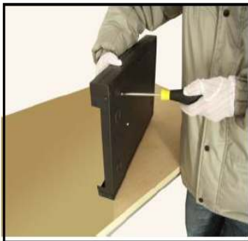
④ fissare la vite del disco rigido
