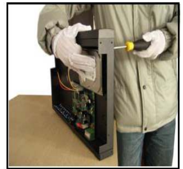
③ fissare la vite del disco rigido
