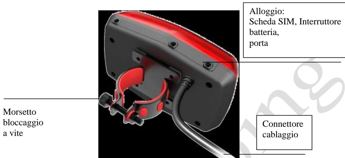
Dispositivo anti-pioggia, antenne GPS e GSM integrate, shake-sensor integrato.
