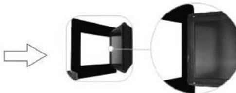
3. Per installare una nuova cornice, inclinare leggermente il pannello posteriore e inserire i due tasselli sul lato del pannello nei supporti corrispondenti sul lato della cornice. Abbassare delicatamente il pannello posteriore premendo la chiusura finché non si aggancia alla cornice.
