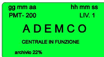
Sulla seconda riga sono visualizzati la sigla della centrale e il livello di accesso alle procedure operative: piu' alto è il livello, maggiore è il numero di procedure accessibili.
