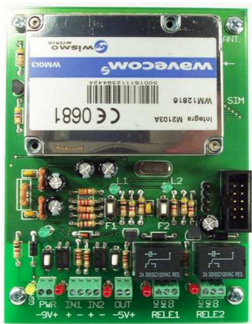
Sistema per controllo remoto GSM
