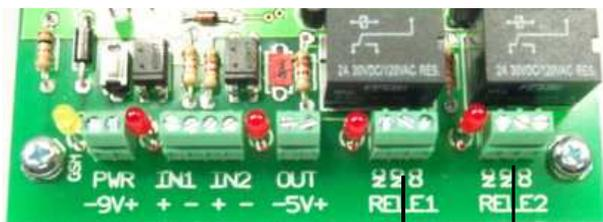
Il modulo TELL22C ha due uscite a relè pilotate tramite comandi SMS, queste uscite sono dei contatti di scambio
