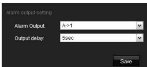
2. Selezionare una delle uscite allarme dall'elenco a discesa **Alarm output** [Uscita allarme], A1 o A2.
