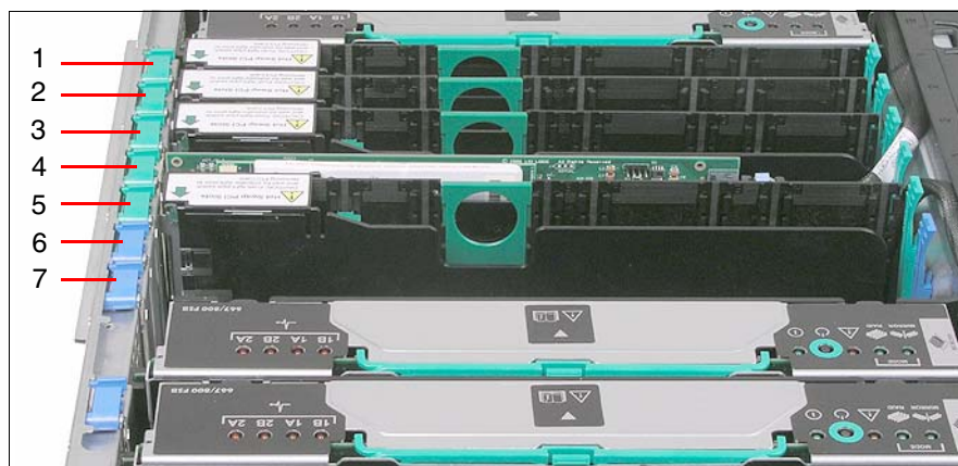
Immagine 30: Slot PCI con e senza funzioni hot-plug
