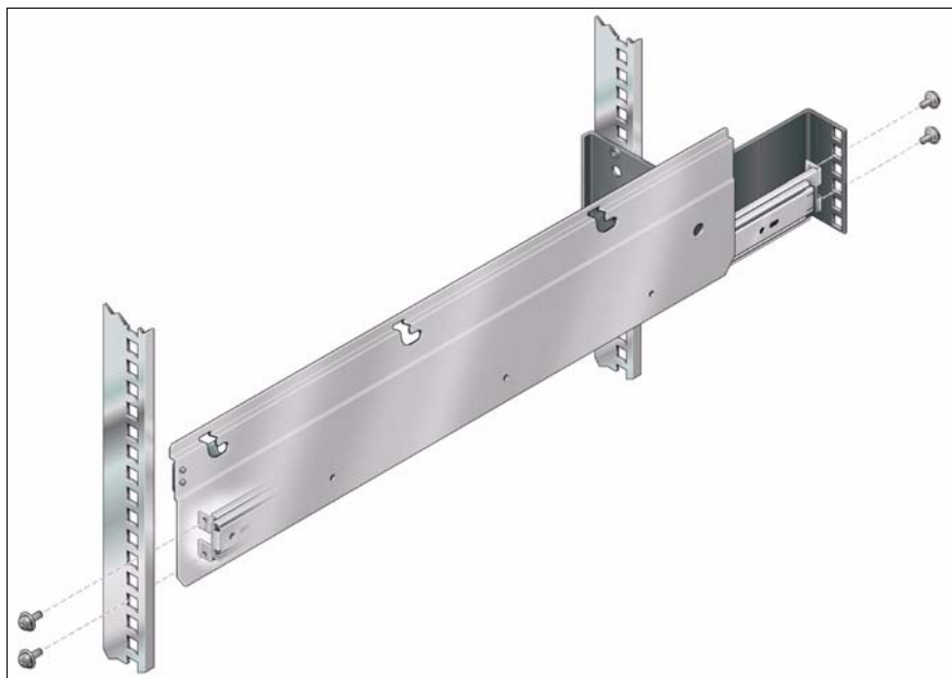
Immagine 4: Montaggio delle guide telescopiche nel PRIMECENTER Rack
