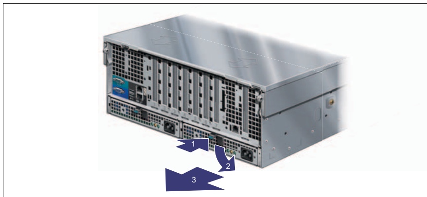
Immagine 21: Sblocco ed estrazione dell'alimentatore
