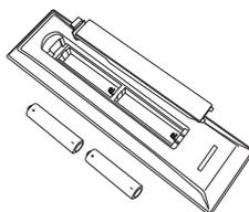
Rimuovere il coperchio posteriore per accedere allo scomparto delle batterie ed assicurarsi che le batterie siano inserite nel senso giusto. Le batterie adatte per questo telecomando sono di tipo AAA, 1,5V.
