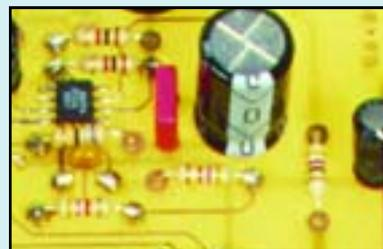
Durante le operazioni di saldatura prestare la massima attenzione al componente SMD (OPA353): utilizzare poco stagno e un saldatore con una punta sottile.
