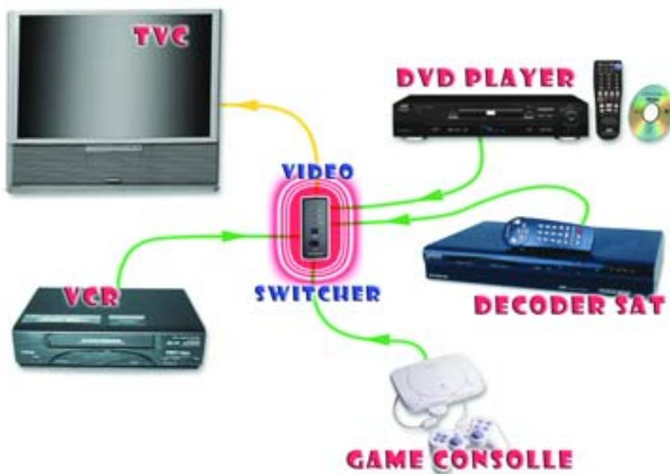
tre prese SCART distinte ma, a volte, anche queste non sono sufficienti per collegare tutti i dispositivi in proprio possesso. Ecco che, in questi casi, risulta estremamente utile disporre di un video switcher che consenta di poter connettere ad una sola presa SCART più dispositivi potendo selezionare a piacere quello da visualizzare. Il progetto
