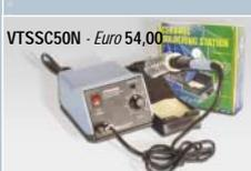
Regolazione della temperatura: manuale da 150° a 420°C, massima potenza elemento riscaldante: 48W, tensione di lavoro elemento saldatore: 24V, led di
