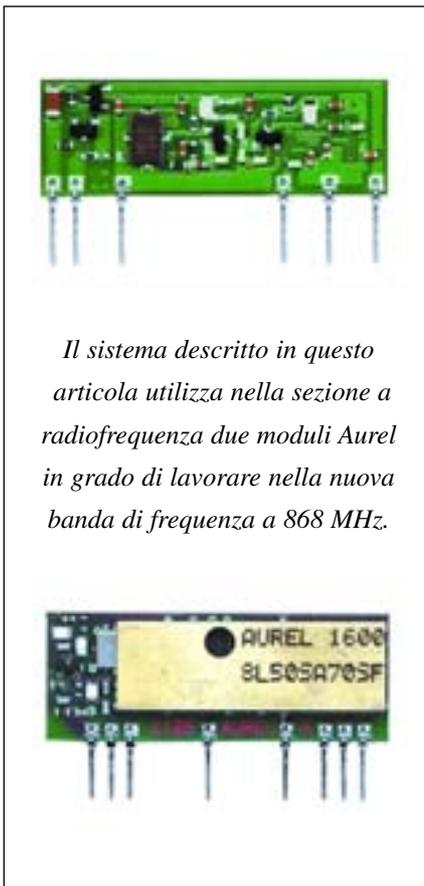
*Il sistema descritto in questo articolo utilizza nella sezione a radiofrequenza due moduli Aurel in grado di lavorare nella nuova banda di frequenza a 868 MHz.*
