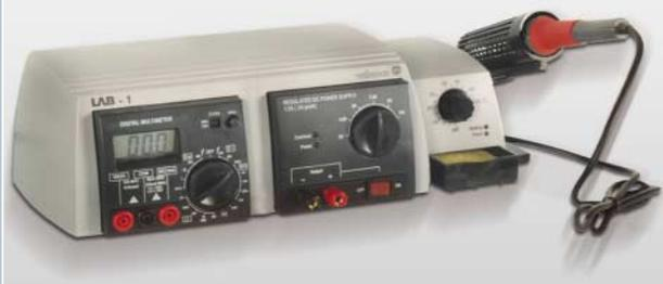
Occupi lo spazio di un apparecchio, ma ne mette a disposizione tre. Questa unità, infatti, integra tre differenti strumenti da laboratorio: una stazione saldante, un multimetro digitale e un alimentatore stabilizzato con tensione d'uscita selezionabile.
