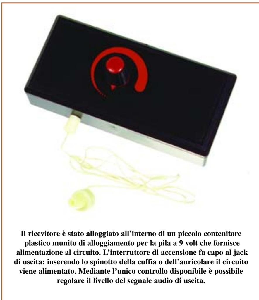
**Il ricevitore è stato alloggiato all'interno di un piccolo contenitore plastico munito di alloggiamento per la pila a 9 volt che fornisce alimentazione al circuito. L'interruttore di accensione fa capo al jack di uscita: inserendo lo spinotto della cuffia o dell'auricolare il circuito viene alimentato. Mediante l'unico controllo disponibile è possibile regolare il livello del segnale audio di uscita.**
