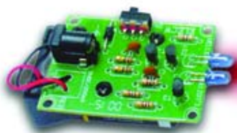
Una bella immagine della barriera ad infrarossi descritta in questo articolo. La portata massima del nostro sistema è di circa 4 metri.
