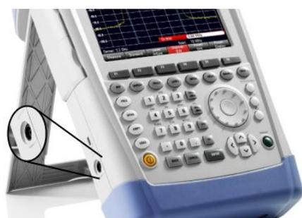
L'R&S FSH è alimentato con l'alimentatore-trasformatore AC/DC attraverso il connettore DC. È anche possibile utilizzare il connettore DC per caricare la batteria.
