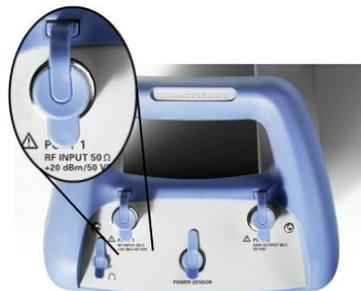
Collegare l'ingresso RF a un cavo o al DUT mediante un connettore N. Se necessario, utilizzare un cavo per collegare il DUT all'R&S FSH.
