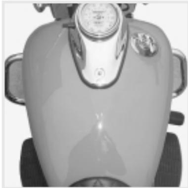
1. Inserire la chiave e ruotare a destra per aprire il tappo del serbatoio carburante.
